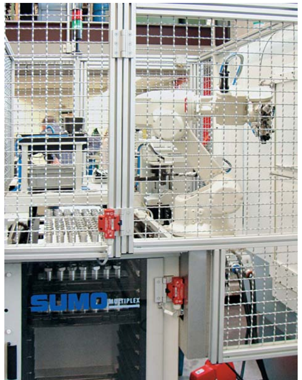
Das Palettiersystem „SUMO Multiplex“ ist vielseitig sowie flexibel einsetzbar und kann 12 Werkstückpaletten bevorraten.
