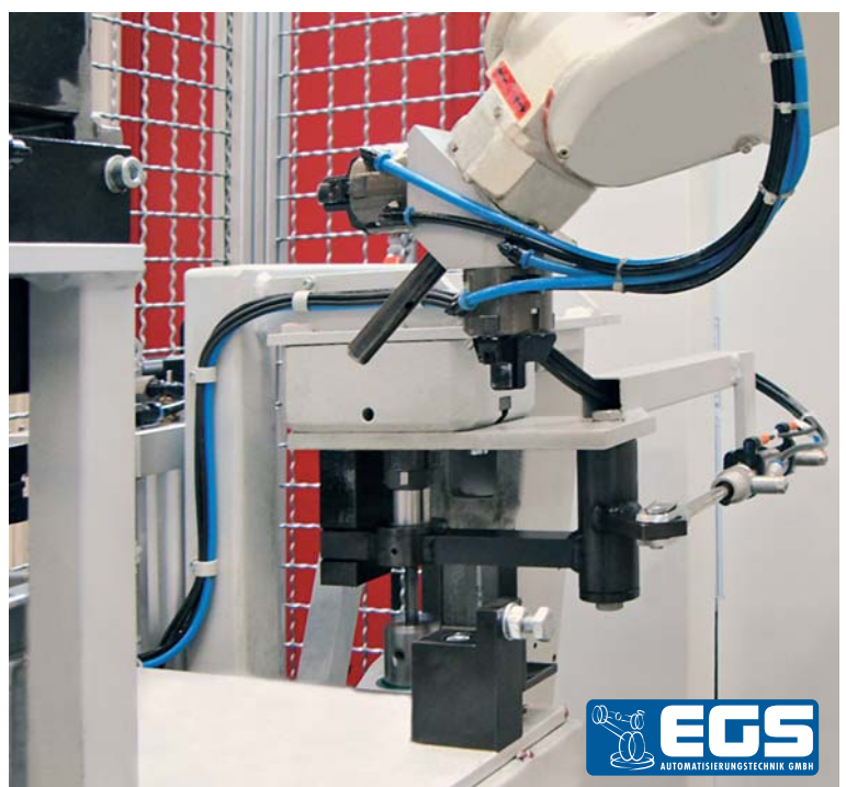
Da der MOTOMAN-HP3L mit einem Doppelgreifer ausgestattet ist, entfallen unnötige Wege.
