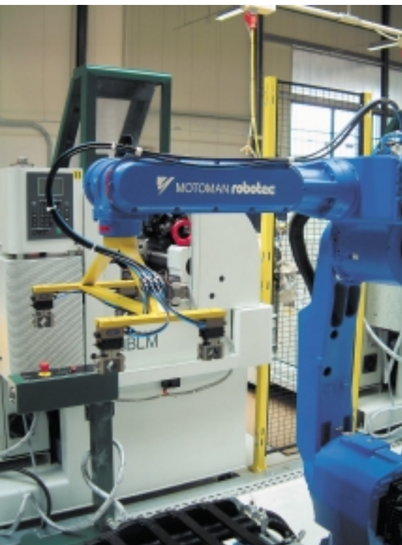
MOTOMAN UP 20 mit Doppelgreifeinrichtung
